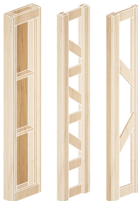
3. Schémas représentant l'évolution de l'assemblage des poteaux, de gauche à droite : conception initiale par l'artisan ; modélisation par les architectures ; prototype réalisé par les deux parties. © Sophie Jacquemin.
