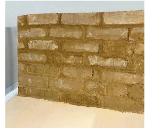
Mur en brique de terre crue compressée, utilisé dans le cadre des expériences
